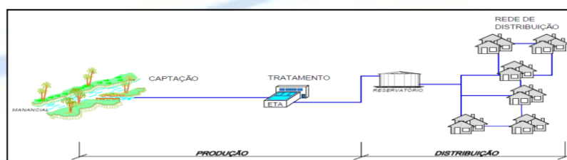
FIGURA 1 – ESQUEMA SIMPLIFICADO DE UM SISTEMA DE ABASTECIMENTO
